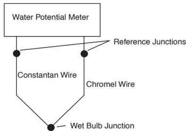
*Figure 3: Thermocouple*
