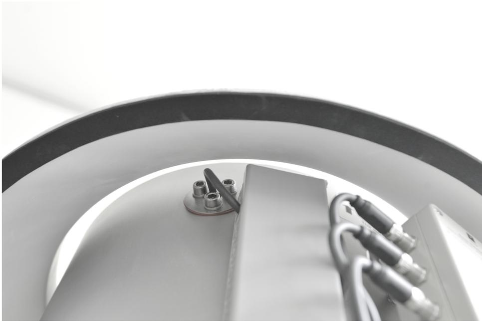
Der Lysimeterkragen darf das Lysimeter an keiner Stelle berühren!
